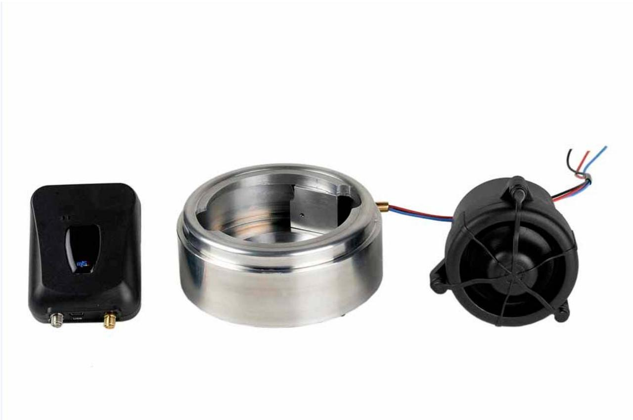
Trattasi di un pezzo lavorato che viene interposto tra il serbatoio del carburante ed il tappo di chiusura. Il pezzo viene fissato al serbatoio per mezzo di viti a testa piatta ed è dotato di un interruttore elettrico (Micron) che invia un segnale ( ad un sistema di allarme oppure al sistema satellitare montato sulla macchina) ogni volta che il tappo viene aperto.
