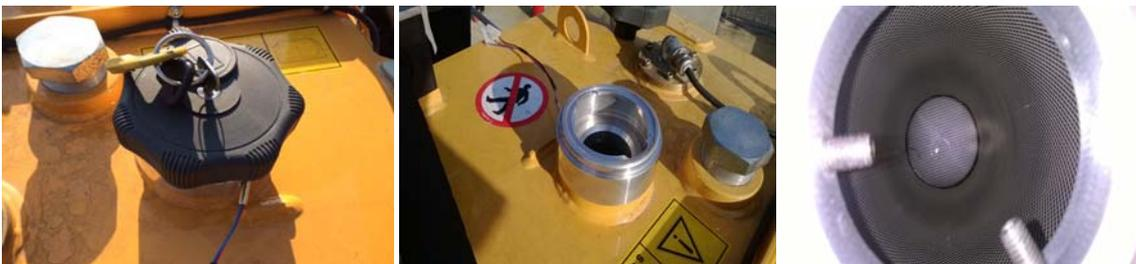
Particolare montato sul serbatoio. Il componente è compatibile con tutti i tappi LIEBHERR
